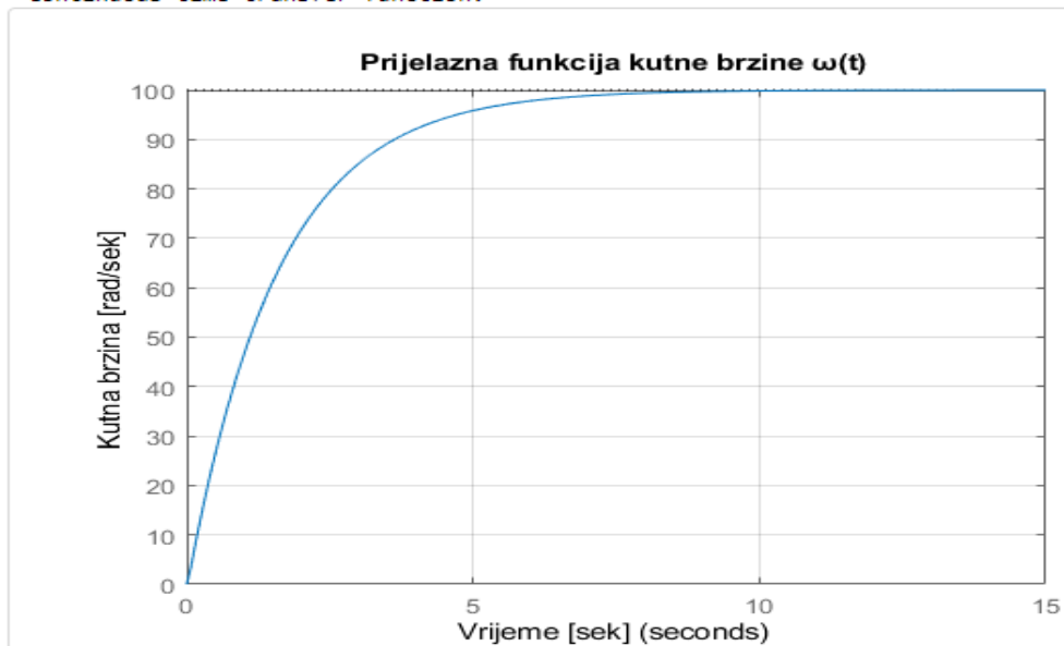
Sl. 2.16 - prijelazna funkciju kutne brzine \omega(t) na step pobudu
