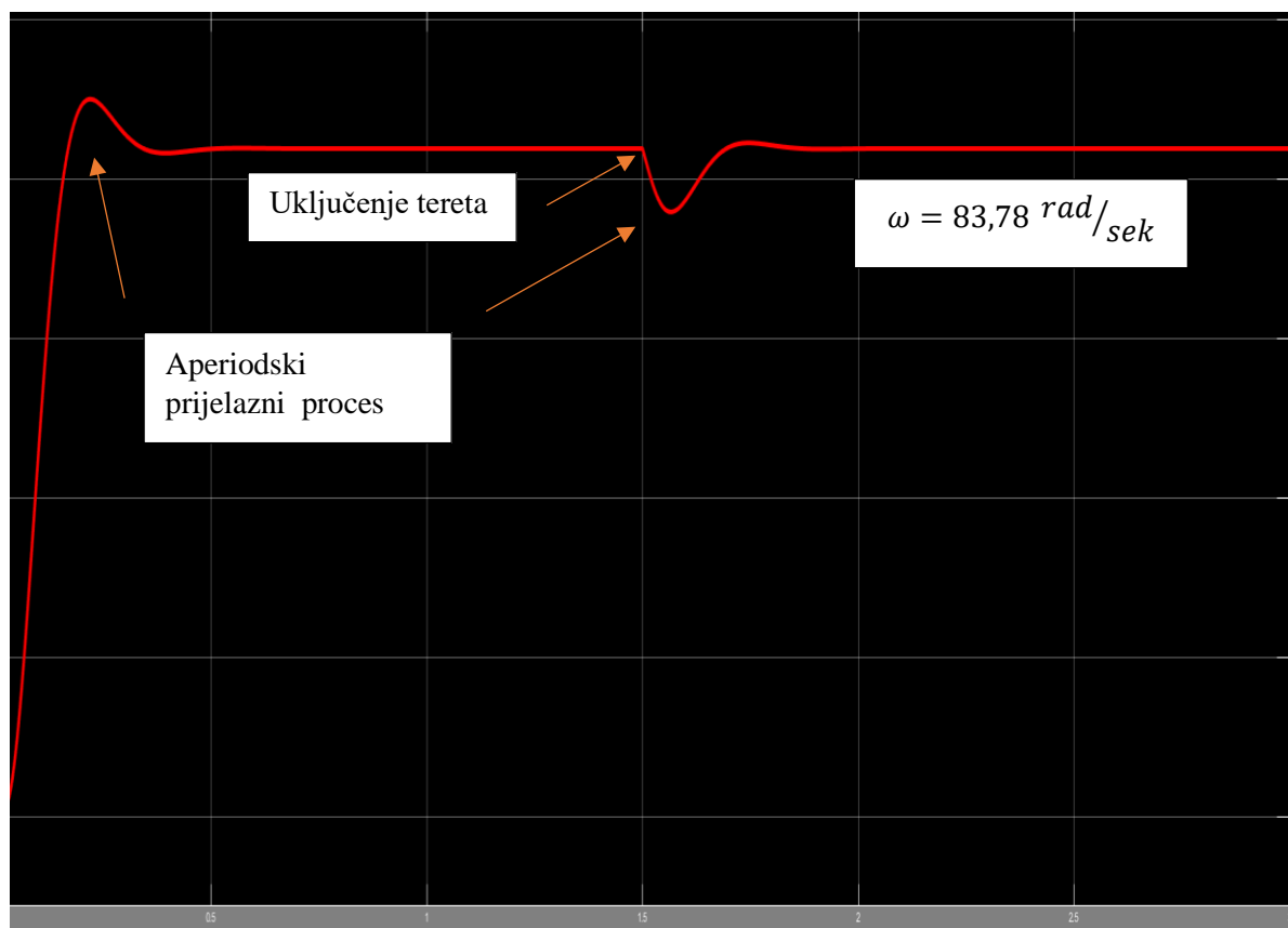
Sl. 3.59 – Prijelazni funkcija kutne brzine i uključivanje tereta u ustaljenom stanju
